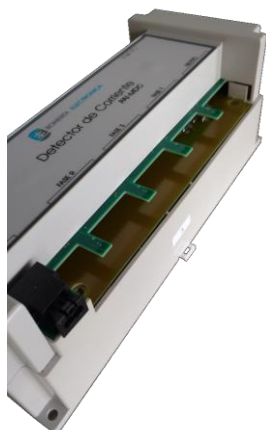
PAI-MDC con la bornera extraída
